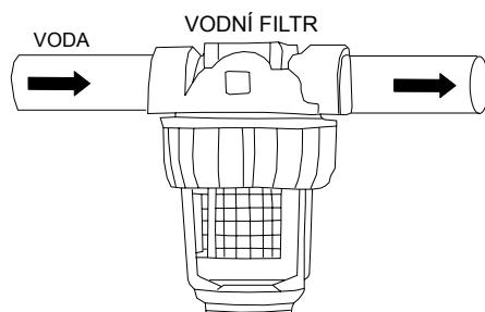
Na přívodu vody musí být nainstalován vodní filtr
