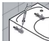
Skryté upevnenie Plug Fix
